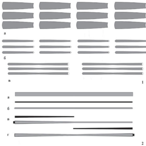
Рис. 4. 1-2 – два способа изготовления биконических полых трубок.
