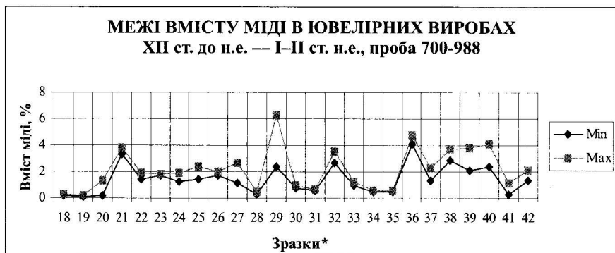
Рис. 4. Варіювання вмісту міді в сплавах другої групи
