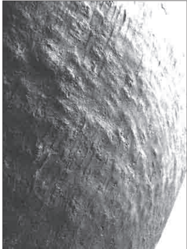
Рис. 5. Сліди кування на зовнішній поверхні
