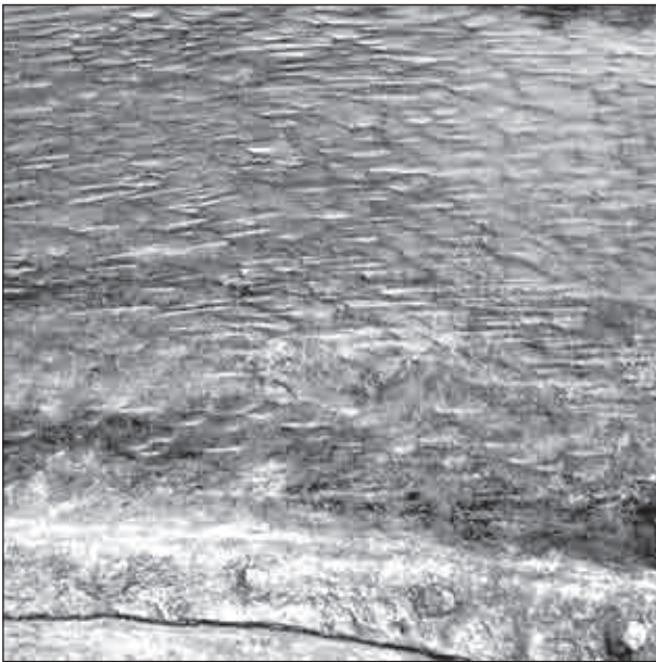
Рис. 4. Сліди кування на внутрішній поверхні
